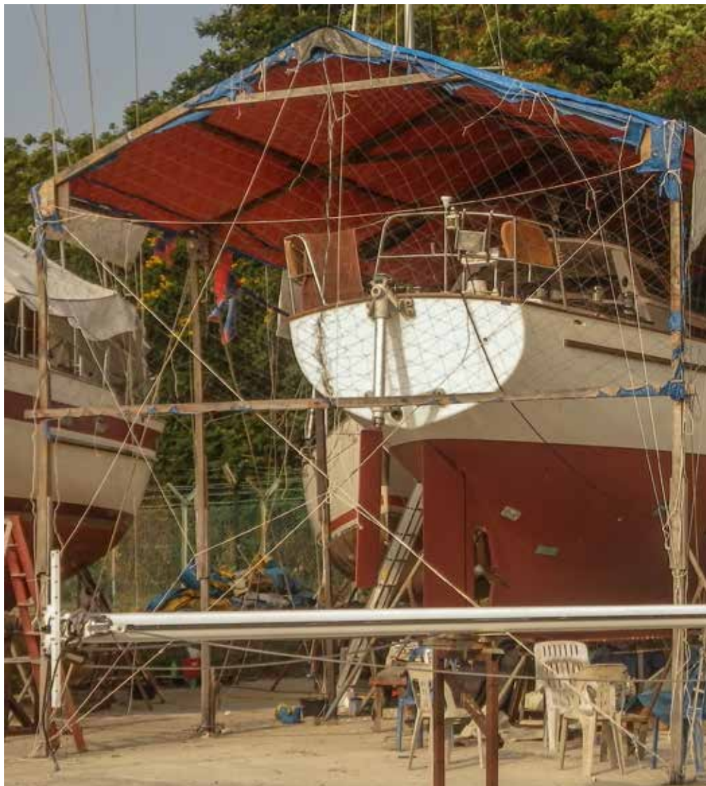
Moon med sin intäckning som gjorde det möjligt att jobba med ett öppet däck utan luckor trots häftiga regn.
