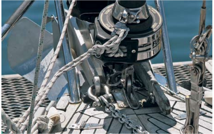
Rättvänt schackel med olika tjocka brickor för att skydda läspinnen.
