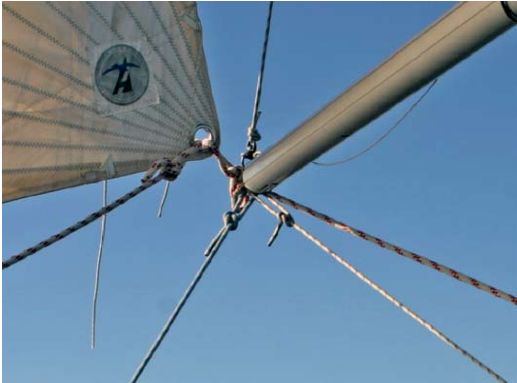
Spirbommen med löpande skot och låst med tre linor.
