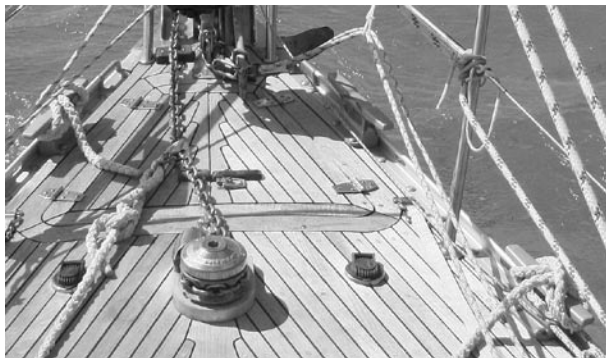
Kättingkrok med lina till springknap avlastar/skyddar ankarspelet. Arbetslasten från ankaret tas av hanfoten, fastgjord i förliga knapen.
